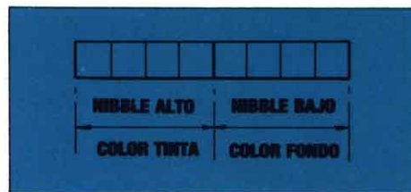
Figura 3.—Composición de colores en la tabla de color en el modo de texto de 32 columnas.
